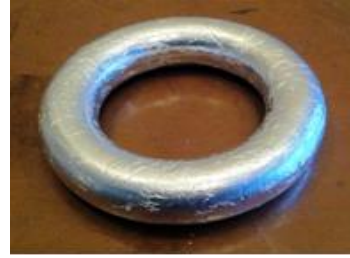
Şekil 7: Toroid biçiminde çıkış elektrodu.
