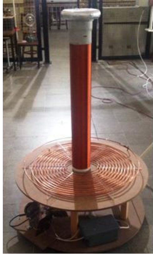
Şekil 10: Gerçeklenen 300 kV, 150 kHz Tesla üretici.
