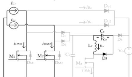
d-) mode-4:  $t_3 < t < t_4$
