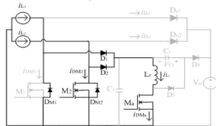
c-) mode-3:  $t_2 < t < t_3$
