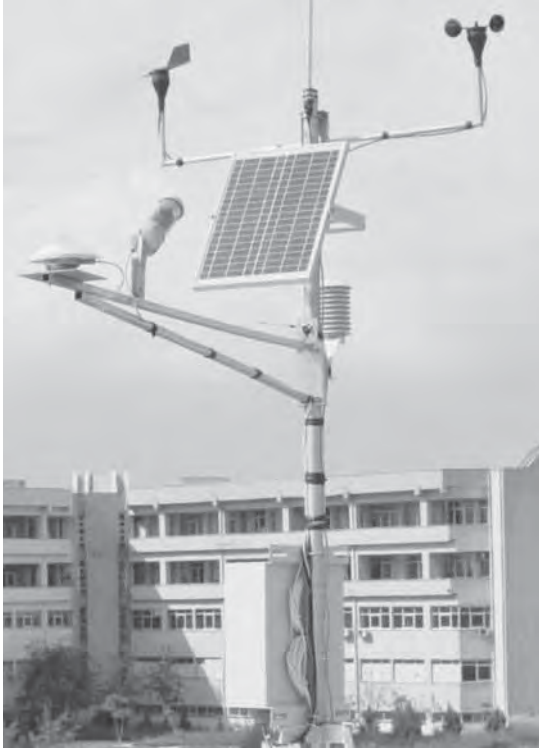
Şekil 2: Güneş ölçüm istasyonun yandan görünümü
