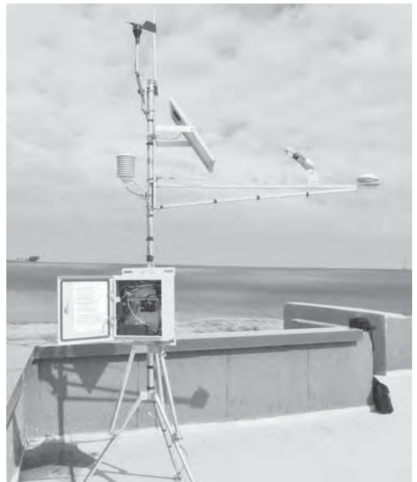
Şekil 1: Güneş ölçüm istasyonun yandan görünümü
