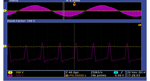
Şekil 22: Gerilim Çökmesi Durumu, Tam Yük, Negatif Çevrim DGM Anahtarlama
