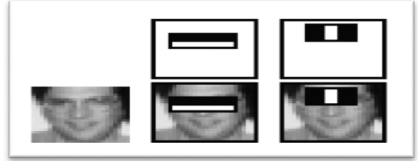
Şekil 3: Yüz için Haar benzeri özellik elde edilmesi [24].
