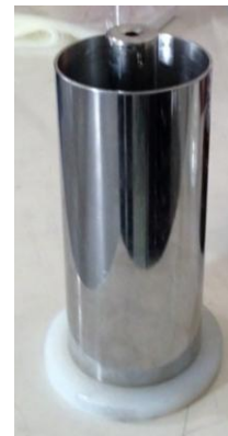
Şekil 7: Gerçeklenen eş eksenli silindir elektrotlu deney kabı.
