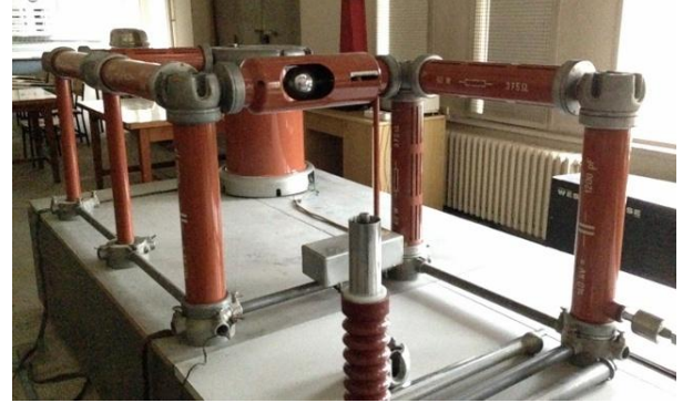
Şekil 9: Kurulan tek katlı darbe gerilimi deney devresi.
