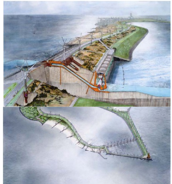
Şekil 5 Açık denizlerde kurulması planlanan pompalı depolama sistemi
