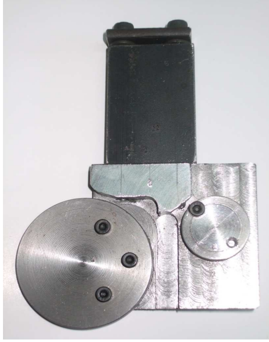
Şekil 8. Halat teli ve demeti çekme aparatı prototip 4
