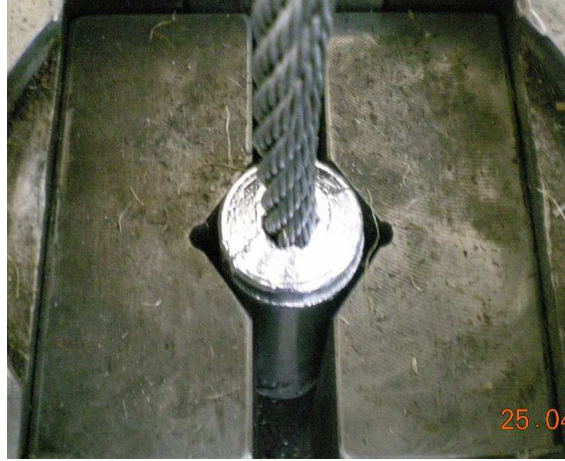
Şekil 10. Halat Çekme Testi
