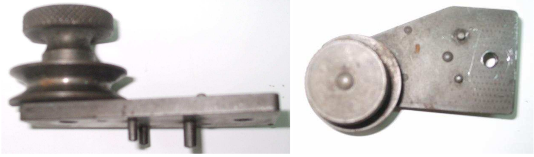
Şekil 6. Halat teli çekme aparatı prototip 2
