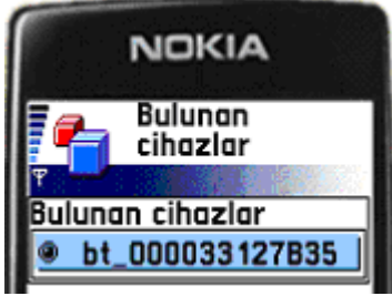
Şekil 6: Bluetooth cihaz arama sorgulamasında E_1 mesaj gönderici emülatörü tarafından bulunan bt_000033127B35 adresli E_2 cihazı, cihaz arama sonucunda şifreli veri gönderilecek E_2 seçilir.
