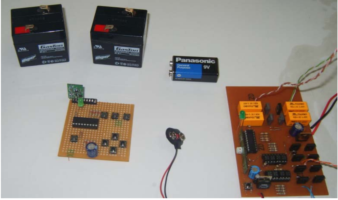
Resim 4.7 Alıcı devre , uzaktan kumanda devresi ,aküler ve pil
