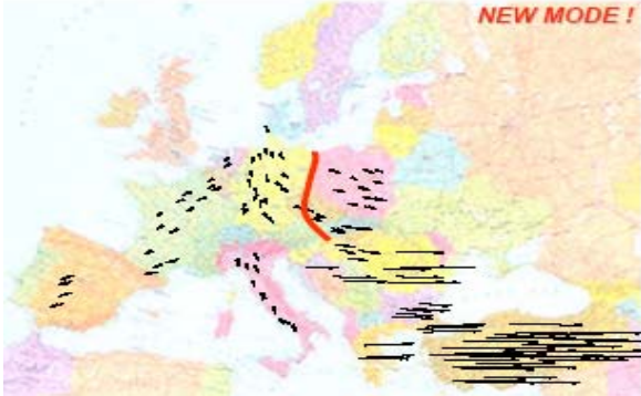
Şekil 1. Enterkonneksiyon sonrası oluşması beklenen \sim 0.15 Hz bölgeler arası salınının mod şekli dağılımı [2].
