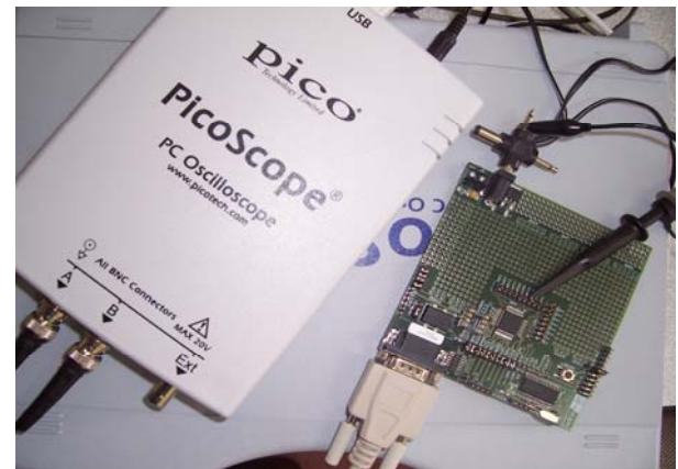
Şekil 5: FPAA-tabanlı gerçekleştirim için deneysel kurulum. Bu kurulumda Anadigm firmasının AN221E04 tipi FPAA uygulama kartı kullanılmıştır [9].
