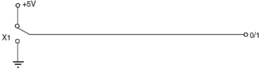
Şekil 9.28 Şema 137: Yüksek-düşük sensör
