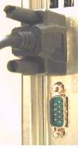
Şekil 16.18 (a), Seri kablo com port bağlantısı (b) Kablo ve Piller Karta takılıdır
