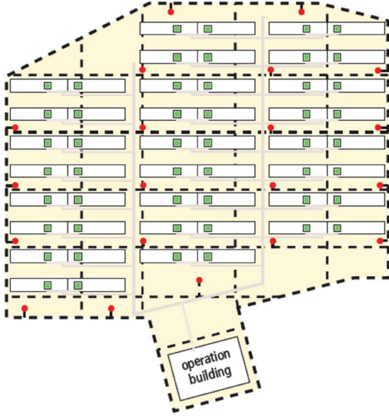
Şekil 6 :Güneş Sahalarında Ağ topraklaması
