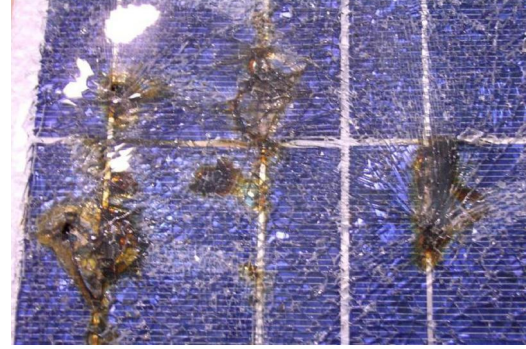
Şekil 10 :Zarar Görmüş Güneş Paneli
