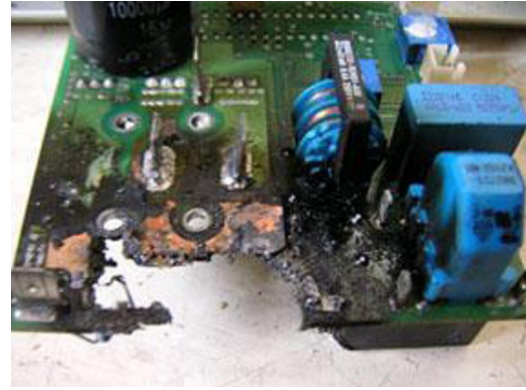
Şekil 10 :Zarar Görmüş Elektronik Panel
