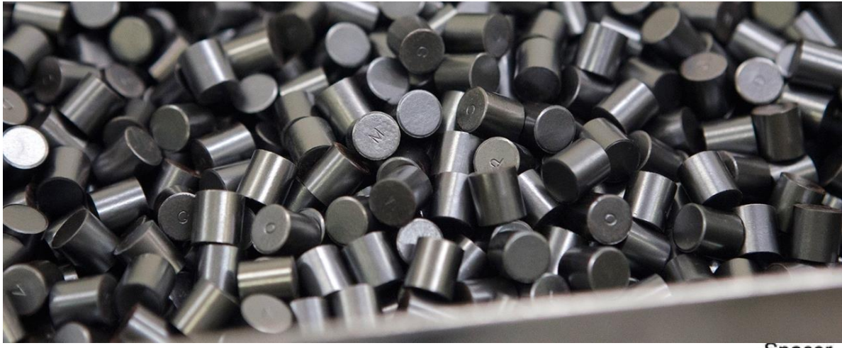
Sinterlenmiş yakıt peletleri
