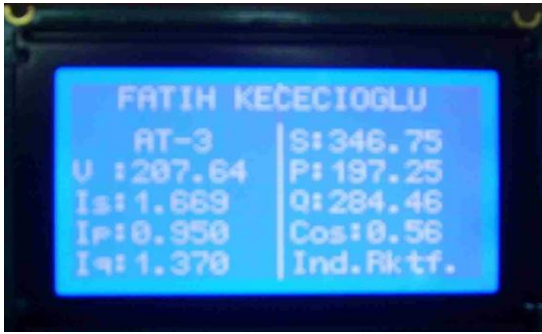
Şekil 5: SVK devre dışıyken goertzel algoritması ile elde edilen değerler
