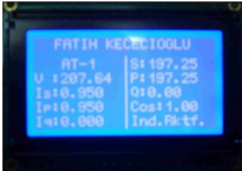
Şekil 6: SVK devredeyken goertzel algoritması ile elde edilen değerler
