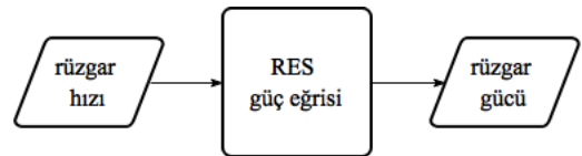
Şekil 1: Rüzgar hızından rüzgar gücüne geçişin akışı.
