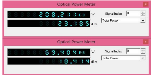
Şekil 8: 1 x 3'lük güç ayırıcının öncesinde ve sonrasındaki güç karşılaştırmaları.
