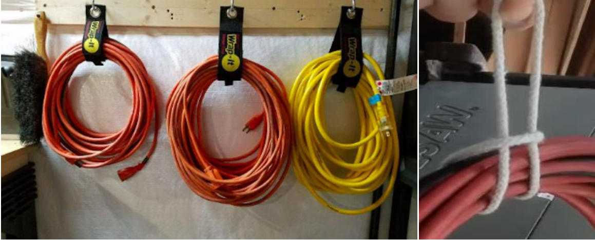
Fotoğraf 5: Askı şeklinde kullanılacak uzatma kablolarının 6kg altında olmasına özen gösterilmelidir. Bu ağırlıktan fazla ise zemine yatırılmalıdır. Üzerine başka yük konulmamalıdır.
