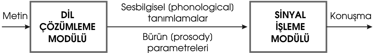
Şekil-1 MKS sistemi blok şeması
