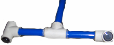
Şekil-6: ultrasonik alıcı vericilerin bastona yerleştirilmiş hali
