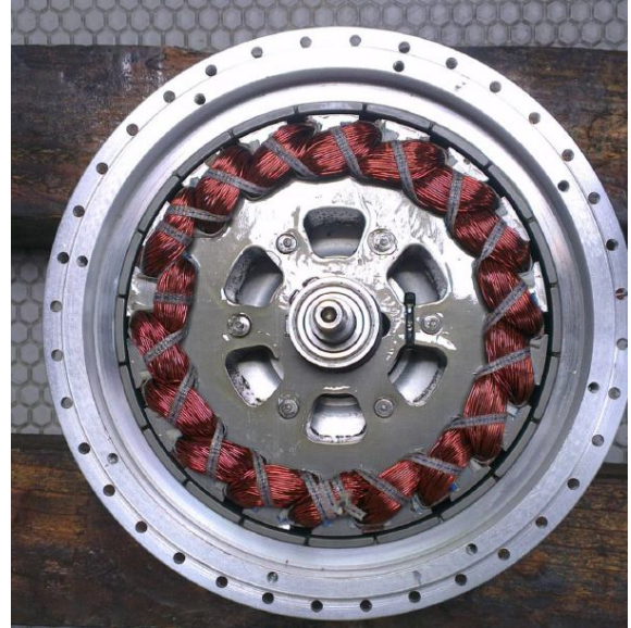
Şekil 12. Prototip motorun gövdeye yerleştirilmiş hali
