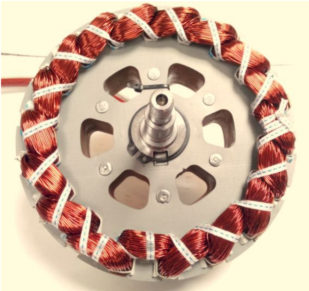
Şekil 10. Prototip stator yapısı ve sargılar
