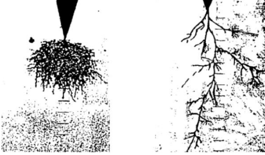
Şekil 1: 50 Hz 20 kV deney geriliminde ağaçlanma.
