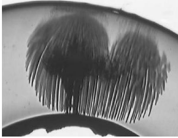
Şekil 2: 0,1 Hz 20 kV deney geriliminde ağaçlanma.
