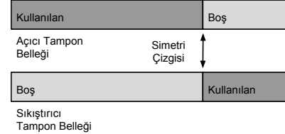
Şekil 6: Aynı piksel işlenirken sıkıştırıcı ve açıcıdaki tampon belleklerin simetri durumu.
