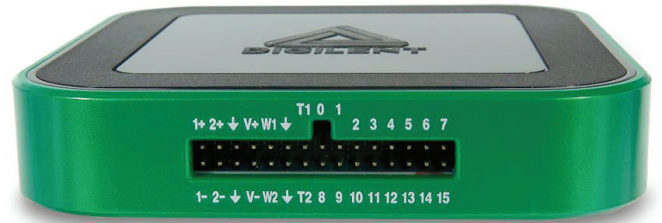
Resim5. AD3 cihazı giriş ve çıkış bacakları.
