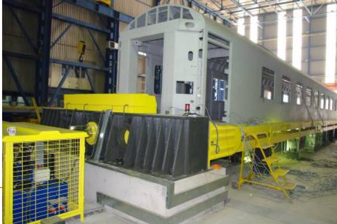
TÜVASAŞ Vagon Gövdesi Statik Test Sistemi
