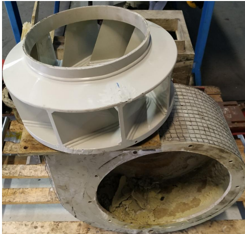
Şekil 3.1: a) Eski Fan Tasarımı, b) Yeni Fan Tasarımı
