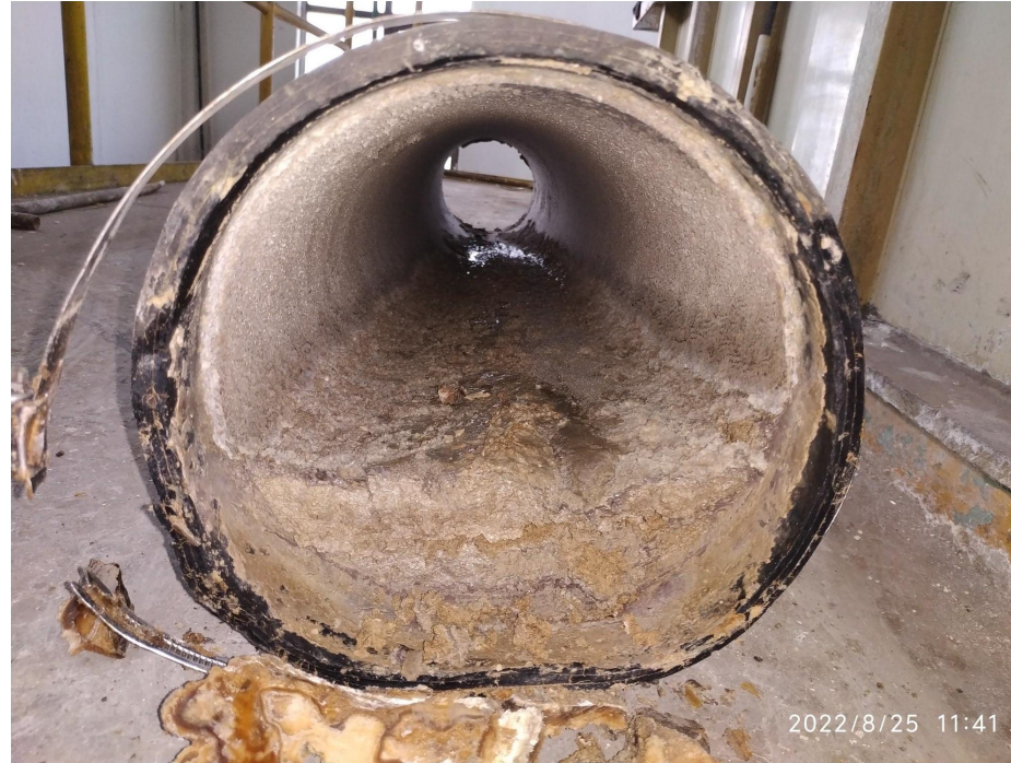
Şekil 2.4: Asit-Baz Birleşimi Kaynaklı Takanmış Boru
