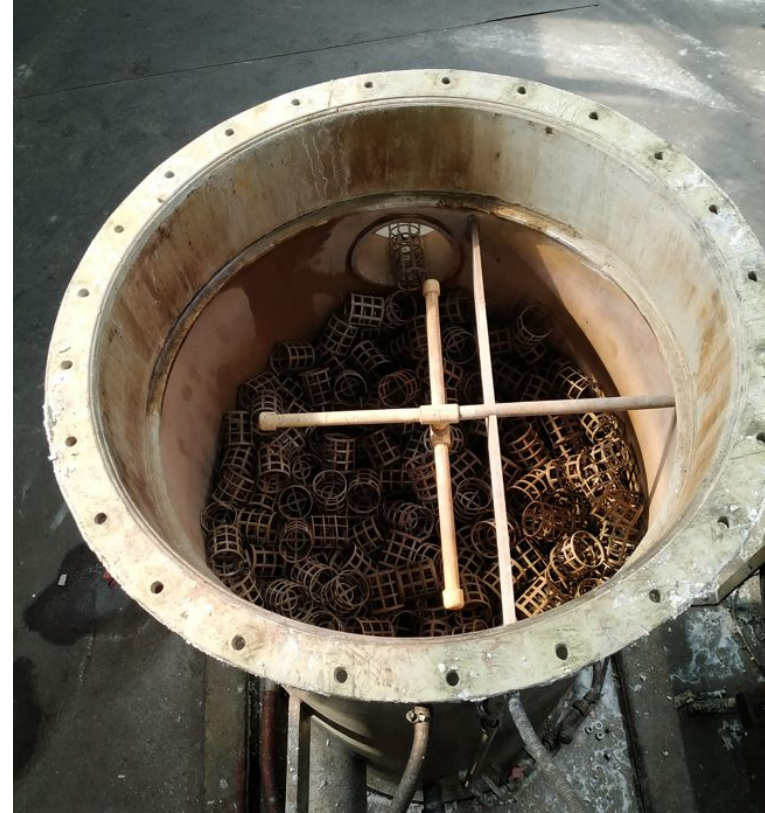
Şekil 3.3 : Yaygınlaştırma ile Değişim Planına Alınan Bigudili Yıkma Tasarımı
