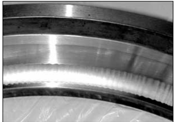
Şekil 5: Yüksek OMG/OMA sonucu yüzeyi aşınmış rulman.
