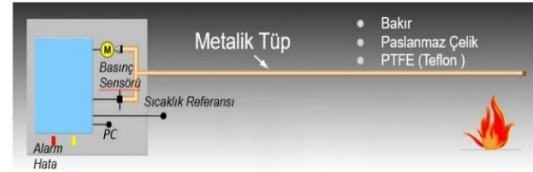
Resim 21. Boru Tipi Doğrusal Sıcaklık Dedektörü Tipik Çalışma Prensipleri
