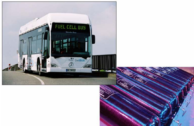
Şekil 6: Otobüslerde kompozit hidrojen tanklarının kullanımı (Mercedes) [5,14]
