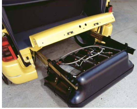
Şekil 4 Peugeot Partner' de yüksek basınçlı hidrojen tanklarının yerleşimi [7]
