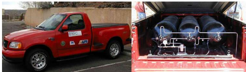
Şekil 3: Bir kamyonet kasasında kompozit hidrojen tanklarının muhafaza edilmesi [7]
