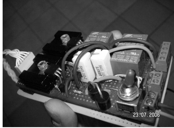
Şekil 6: Motor sürücü devresi
