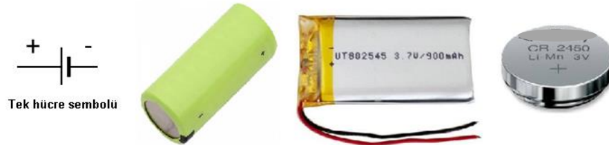
Şekil 8: Tek Hücre (Single Cell)
