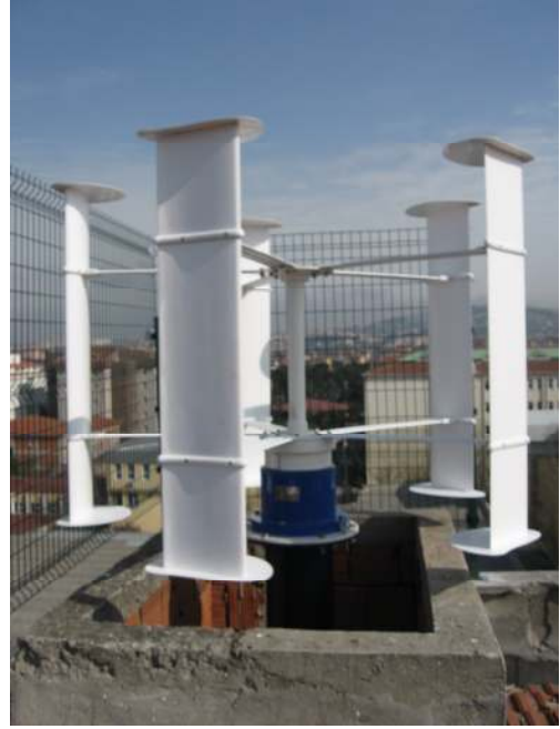
a b Şekil 6.a. Küçük Güçlü Rüzgar Türbini Uygulamasının Prensi Şeması b. Marmara Üniversitesi Göztepe Kampüsündeki Uygulama Görüntüsü
