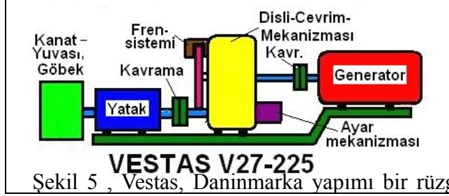
Şekil 5 , Vestas, Danimarka yapımı bir rüzgar makina tipi ve gondel, makina dairesinin şematik yapısı, (Dişli-cevrim mekanizmalı sistemi)
