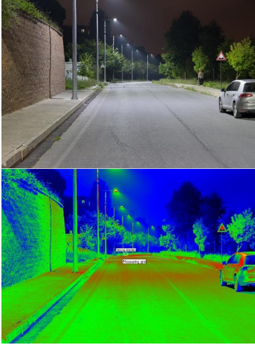
Şekil 3. Test yolu gerçek ve kameralı parıltı ölçer fotoğrafı
