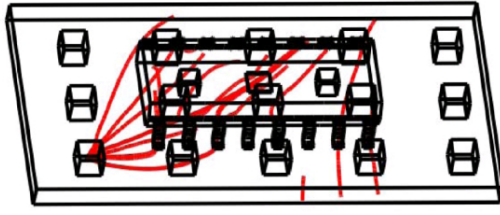
Şekil 4: Isı kaynağının tek bir simgesel alt düzleme konulması ile elde edilen ısı akısı.
