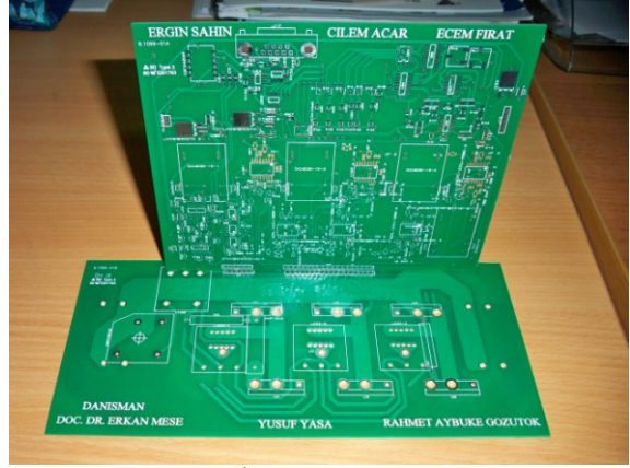
Şekil-11: İnverter devresi yerleşimi
