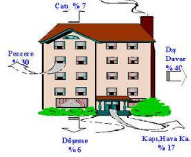
Şekil 1: Binalardaki enerji kayıplarının bina içerisindeki dağılımı
