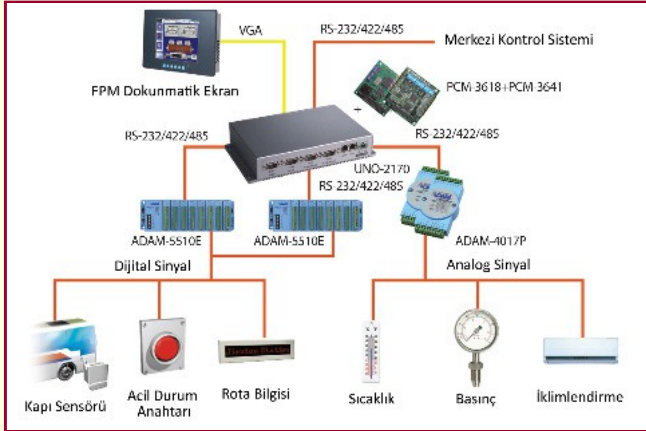
Şekil-2: Raylı sistemlerin kontrol mekanizması.
