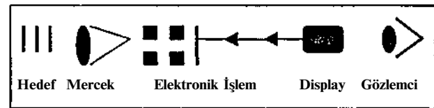
Şekil 1. Bir termal görüntüleyici blok diyagramı[4].
