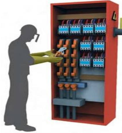
Ağırlıklı 50V-36kV arasında uygulanır Insulating glove working
