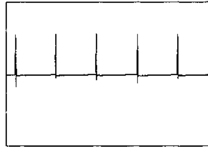
Şekil 3. Tetikleme devre çıkışı (tepeden tepeye 8V ve tekrarlanma frekansı 100 kHz)
