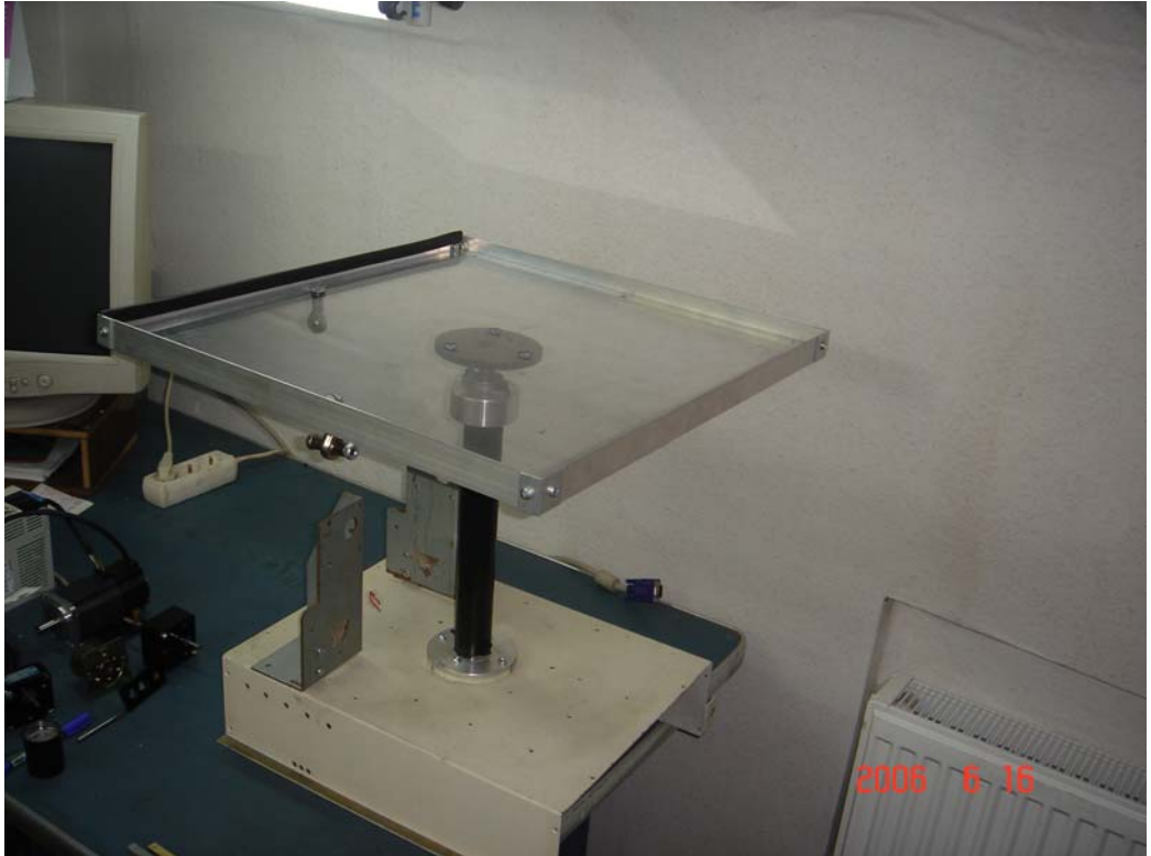
Şekil 10: Top-plaka sisteminin temel iskeleti[2]
