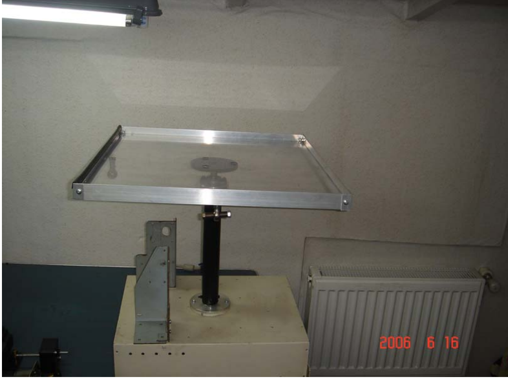
Şekil 9: Top-plaka sisteminin temel iskeleti[1]
