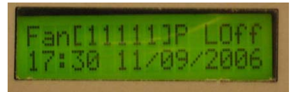
Şekil.6 Aydınlatmalar pasif (LOff), fanlar aktif durumda iken LCD görüntüsü
