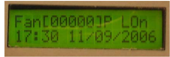
Şekil.5 Aydınlatmalar aktif (LOn), fanlar pasif durumda iken LCD görüntüsü
