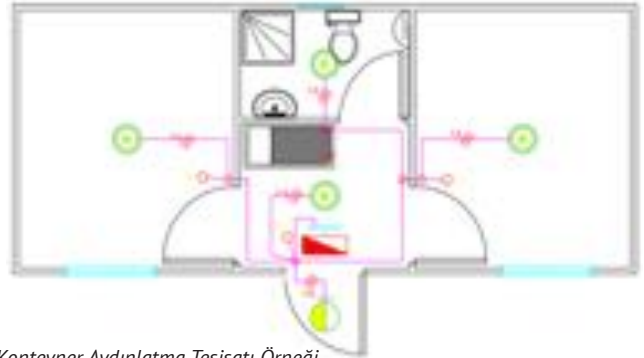
Konteyner Aydınlatma Tesisatı Örneği
