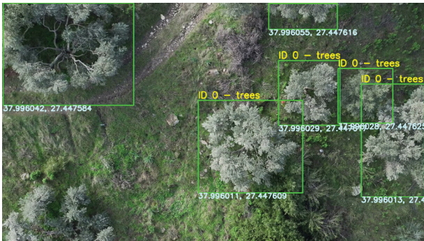
Şekil 8. Video karelerinden birinde gerçekleştirilen ağaç tespiti ve coğrafi konumlandırma sonuçları. Tespit edilen her bir zeytin ağacı yeşil kutularla gösterilmiş, kutuların üzerinde hesaplanan coğrafi koordinatlar verilmiştir.
