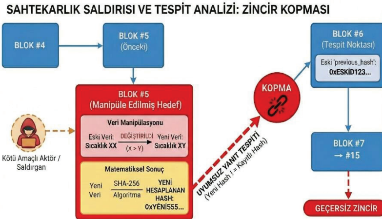
Şekil 8. İHA'nın blokzincir veri yapısı, işlem akışı ve zincir bütünlüğü doğrulama mekanizmaları.
