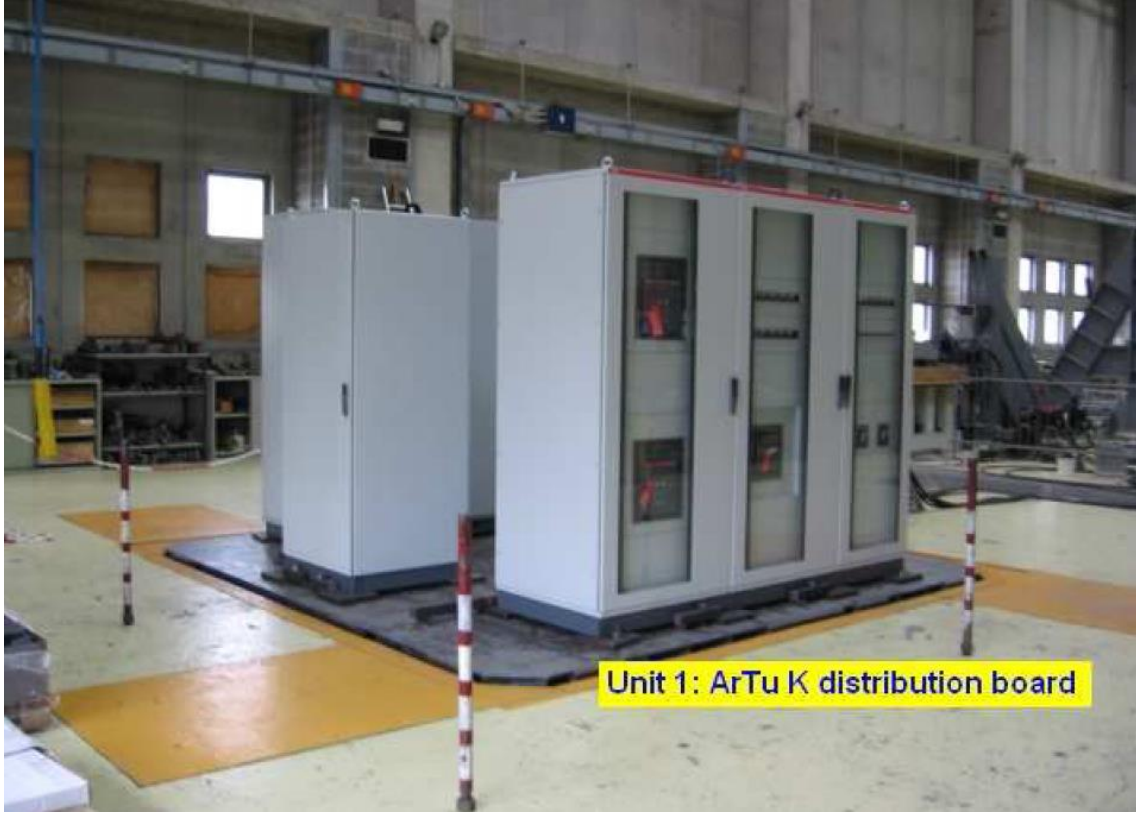
Şekil 8. AG Panolarının test masasına yerleşimi.
