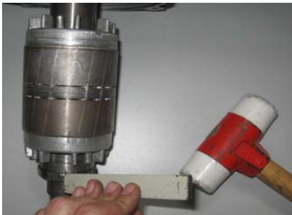
Şekil 8: Rotor parçalarının sıkıştırma işlemi
