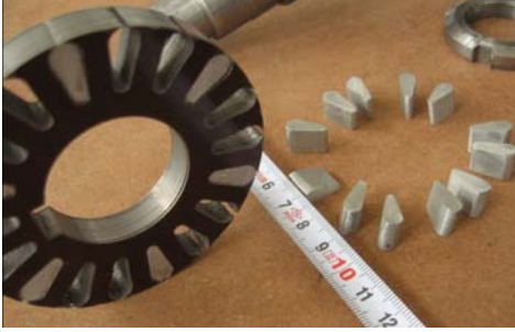
Şekil 6: İmal edilen rotor disk ve alüminyum iletkenleri
