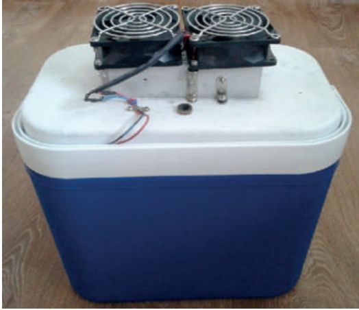
Şekil 2. Peltier'in iki adet TEM'ünden oluşan termoelektrik sistem
