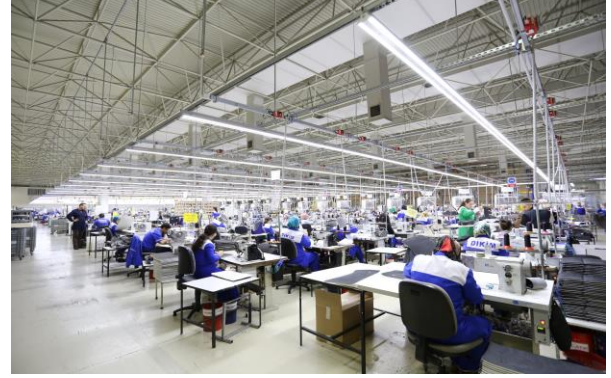
Şekil 6 Tekstil üretim tesislerinde hat üzerinde homojen yayılmış ve istenen yüksek aydınlık seviyesini sağlayacak lineer ürünler tercih edilmelidir.
