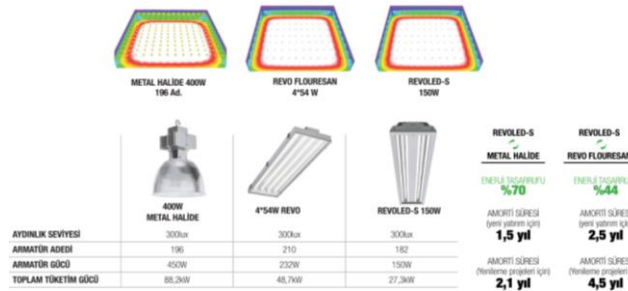
Şekil 5 Yüksek Tavan LED Aydınlatma Armatürünün Konvansiyonel Sistemlerle Karşılaştırması
